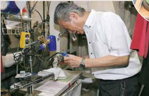
水や溶剤を噴霧する専用の機械を使い、生地を傷めずにシミ抜きを行う
