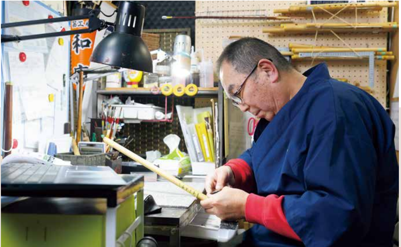
笛づくりでもっともむずかしいのが調律だという。管の内側を部分的に削って音を調節する技術は、「ここを削るとこうなる」と試行錯誤しながら独学で身につけた
