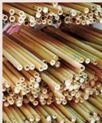
笛の素材となる竹。冬に切り出し、火あぶりして厳選した竹を、3年かけて乾燥させ、割れずに残った竹だけを使う
