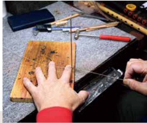
笛に装飾するための「籐引き作業」。仕上げりをきれいにするため、籐の両側を面取りして、0.5mmの幅に揃えていく
