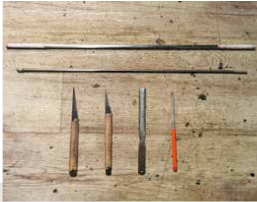
笛づくりに欠かせない道具類。上の長い「ガリ棒」は管の内側を削るのに用いる。左下の小刀は穴を開けるのに使う。いずれも職人に特注してつくってもらっている
