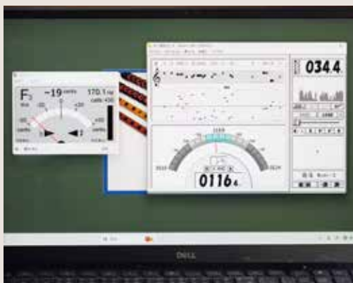
パソコンのチューナーで音程を確認。メーターの青い領域に入るように調律していく。青い領域内の誤差なら、絶対音感の人でもわからないそう
