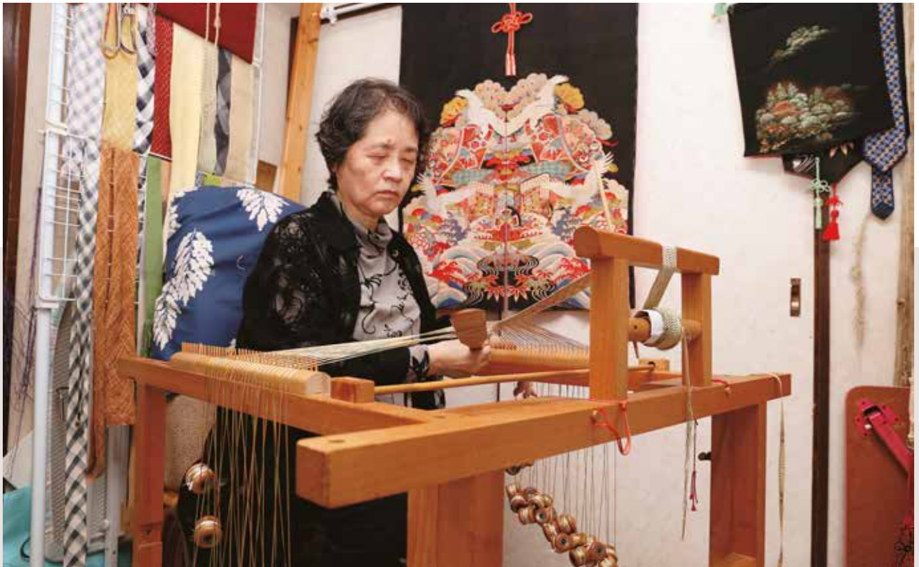
組紐を組むための「高台」。糸の束を交互に組み上げ、ヘラを使って整える。糸の本数を増やすことで、幅の広い組紐をつくることもできる
