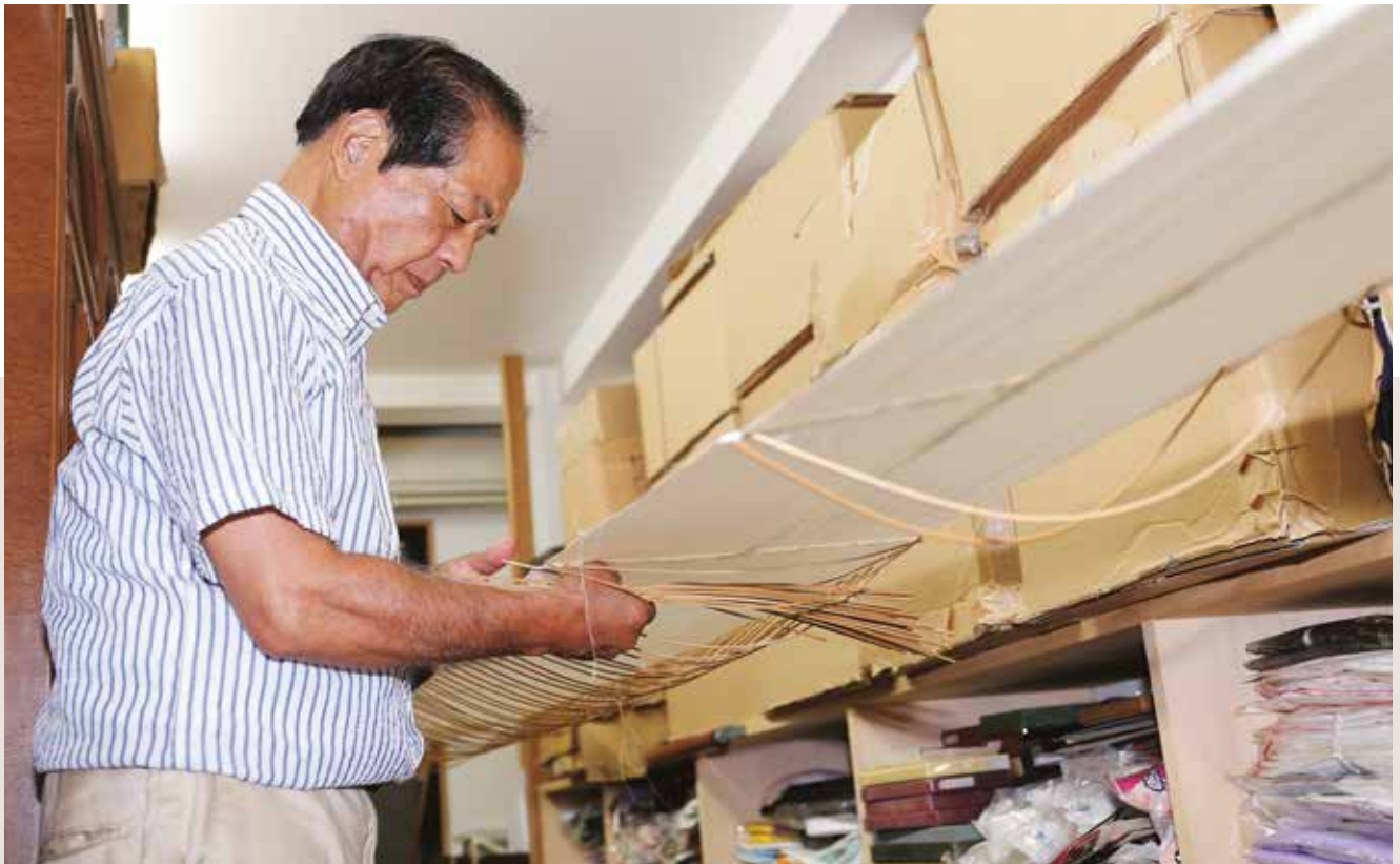
洗濯した生地に、伸子を張ってしわを伸ばす「伸子張り」。伸子を張る間隔は生地ごとに違い、生地に触れた指先の感覚で瞬時に判断する
