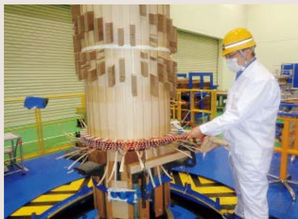
深山さんが確立させた堅型巻線。横型巻線ではねじれてしまう幅の太い電線を巻けるようになり、設計の自由度が増し、耐久性も向上した
