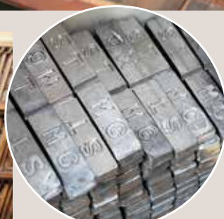
活字の原料となる地金。鉛・スズ・アンチモンで構成されている。この地金を溶かして活字をつくる
