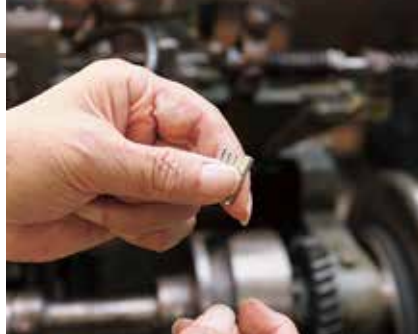
鑄造されたばかりの9ポイントの活字。鑄型により直方体に成形され、その先に凸型の文字がつく
