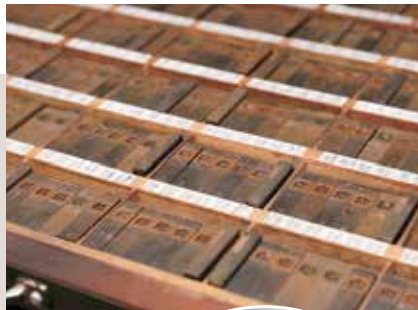
鑄造されたばかりの9ポイントの活字。鑄型により直方体に成形され、その先に凸型の文字がつく
