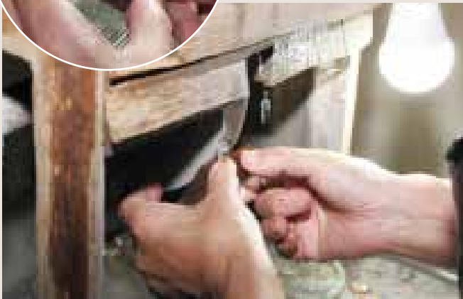
研磨する厚さはわずか0.05mm。手先の感覚を頼りに研いでいく
