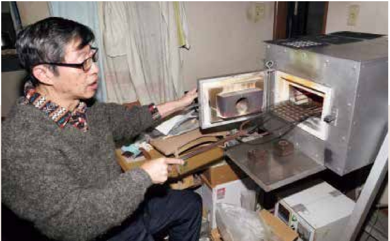
釉薬を盛った土台を800℃前後の炉で焼く。同じ色を2回、さらに異なる色ごとに釉薬を盛って焼き、酸洗いをくり返すことで、美しい色を生み出す
