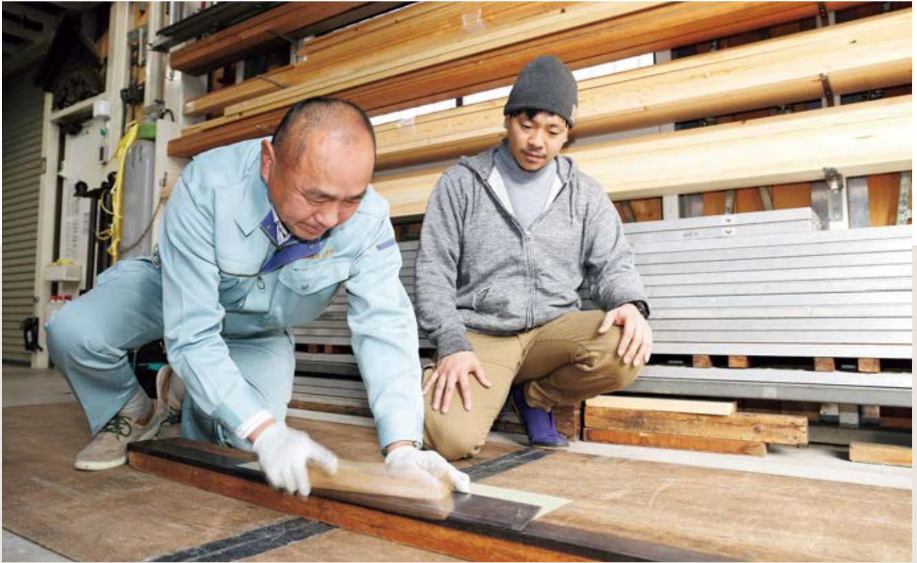
折り台に板を載せ、拍子木 ひょうしぎ で叩いて折り曲げる、板金の基本作業。社員の田村隆幸 たむらたかゆき さん（右）は「一から十までだけでなくプラスαまで教えてくれます」と話す
