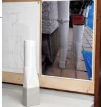
雨どいの変換継ぎ手を銅板で製作。取り替えコストの削減に貢献した
