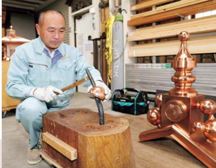
銅板を叩いて丸く加工する「絞り」。均等に叩かないと厚みにムラが出てしまう。右は銅板で製作した洋風鬼瓦
