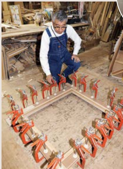
木工の最終工程で、額縁の枠を圧着させている ところ。丸1日置いて、塗りの工程に進む
