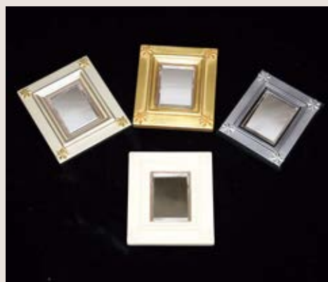
新製品として試作中の手鏡。奥の三つはアンティーク調 に仕上げたもの。手前は額に下地塗りした段階のもの
