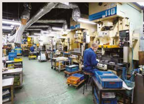
トネ製作所の工場には、プレス加工機、レーザー加工機、曲げ加工をするNCベンダーなど、金属を加工するためのさまざまな設備がそろう
