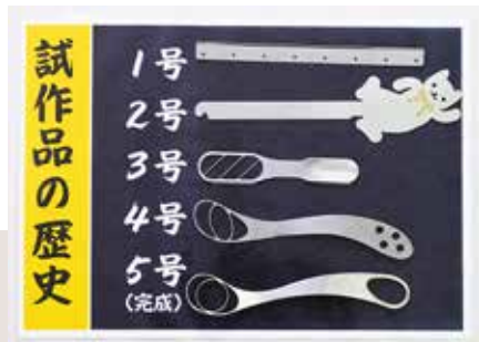
「ときこち」は特殊ステンレス板を加工してつくられる。写真はレーザー加工機で「ときこち」の形に抜いた状態の板
