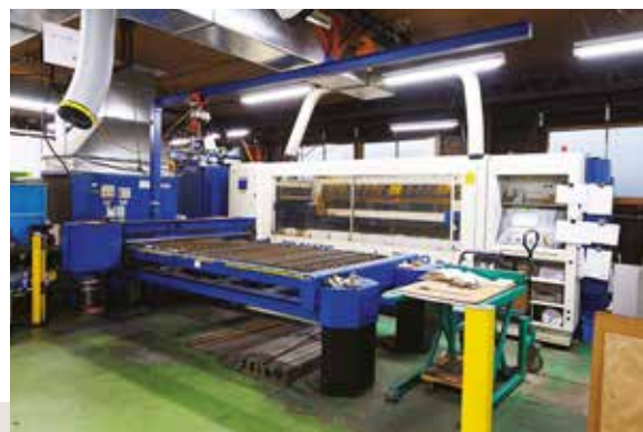
特殊ステンレス板を「ときこち」の形に抜く工程で使用されるレーザー加工機。0.1mm単位の高精度加工が可能
