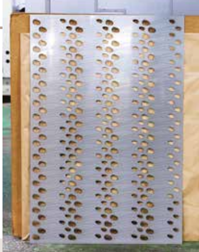
「ときこち」は特殊ステンレス板を加工してつくられる。写真はレーザー加工機で「ときこち」の形に抜いた状態の板
