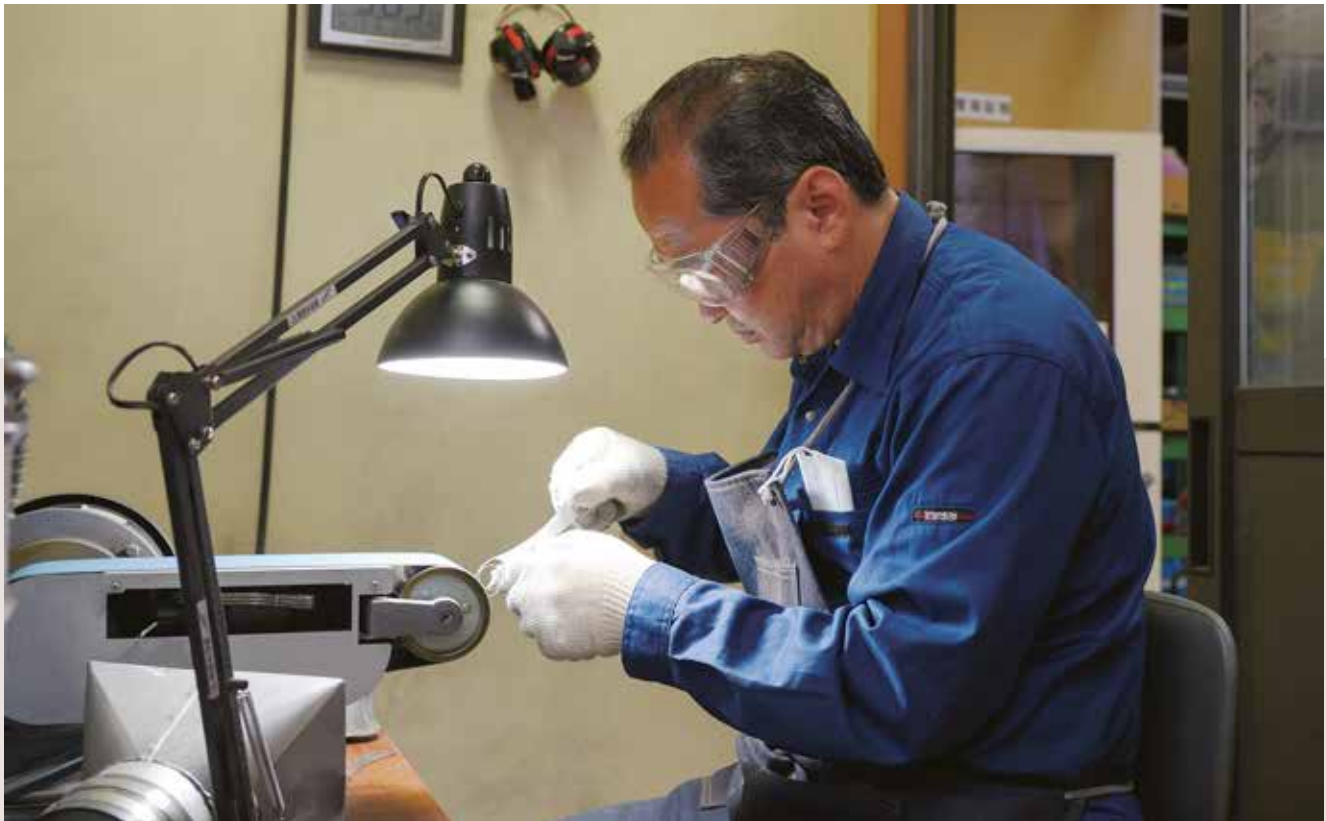
「ときこち」は、触り心地のよさを目ざし、利根さんが1本1本手作業で製造している。写真は、尖った端面を丸く滑らかに仕上げる「削り」の工程
