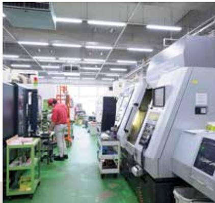
金型を製造するために金属を切断、加工する機械が並ぶ。ここで加工したものを磨き、0.01～0.02ミリ単位で調整するのが及川さんの仕事だ
