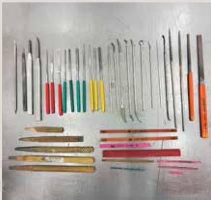
金型をミクロン単位で調整するために使用するヤスリや竹べらなどの道具。竹べらはサンドペーパーで細部を削りやすいように手づくりしたもの（写真提供：株式会社クライム・ワークス）
