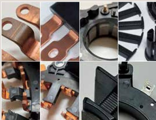
金属の周囲に樹脂を流し込んで一体化させるインサート成形は、さまざまな部品製作に用いられている（写真提供：株式会社クライム・ワークス）
