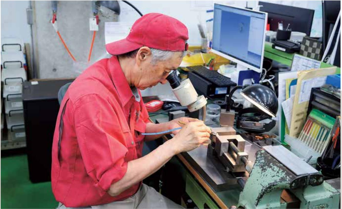
機械加工でできあがった金型の駒を調整する。顕微鏡をのぞきながら、サンドペーパーを当てて竹べらでこすりながら削り、ミクロン単位の調整を行う
