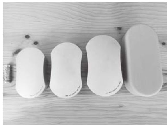
右端が最初期の筐体モック。試作をくり返し、左にいくにしたがい筐体が小さくなっていった。単3乾電池の隣が実際の製品 (写真提供：株式会社 Photosynth)
