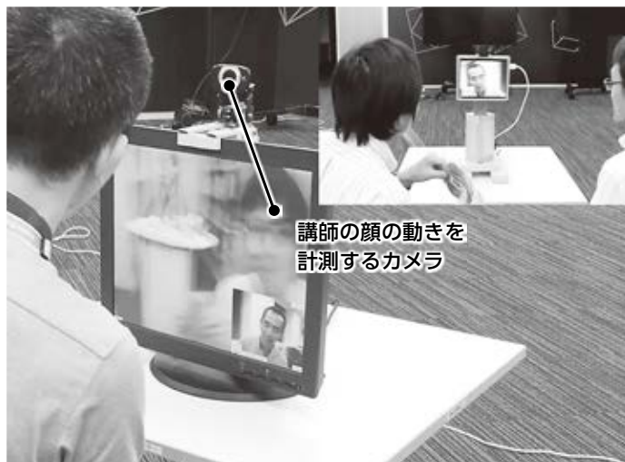
写真2 講師用ロボットのハンズフリー操作の仕組み
