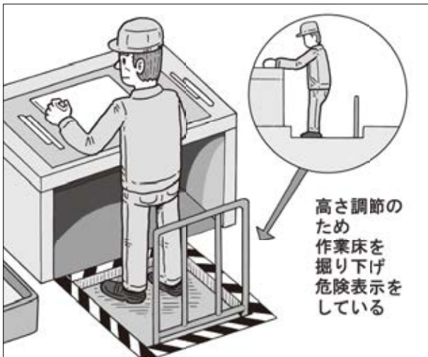
図5 負担の少ない作業姿勢のために作業床を掘り下げた例
