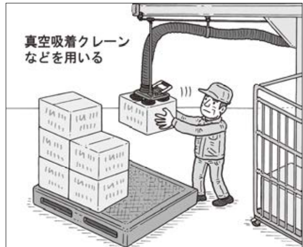
図7 クレーンによる積み込み作業例
