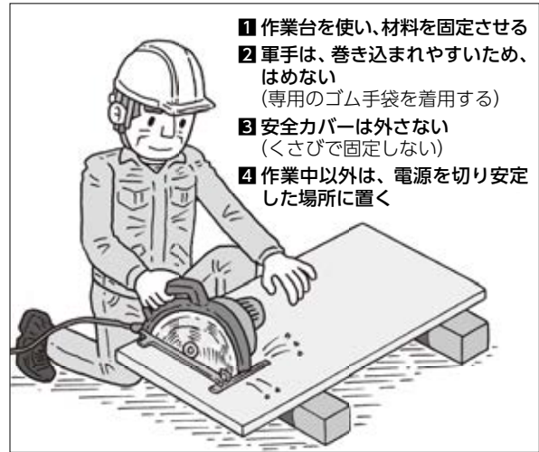
図表4 電動丸ノコ作業の基本
