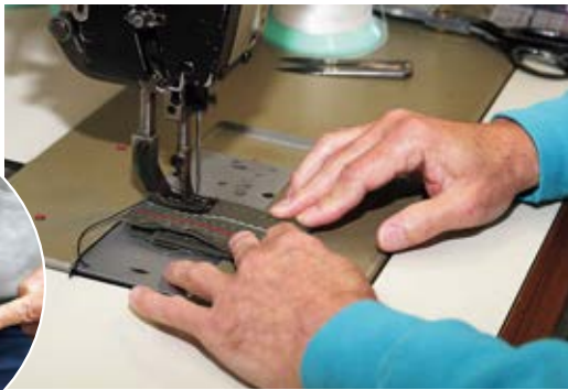
工業用ミシンを使い、最も太いゼロ番の糸で厚い生地を重ねて縫っているところ。経験が求められる技術の一つ
