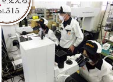
左：金型の品質を顕微鏡で検査する方法を指導。課内だけでなく他部門の社員に測定方法を教えることも多い／右：企業内職業訓練認定校「ミットヨ技能開発センター」の卒業試験にあたる「技能照査試験」で寸法測定を検定（写真は2016年）（提供：株式会社ミットヨ）
