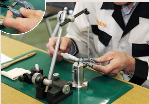
技能検定の一つ、「三針法によるねじプラグゲージの有効径測定」を実演。1/1000mm単位まで正確に測定するには、対象物や工具の清掃も欠かせない
