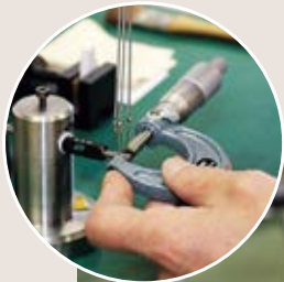
左：金型の品質を顕微鏡で検査する方法を指導。課内だけでなく他部門の社員に測定方法を教えることも多い／右：企業内職業訓練認定校「ミットヨ技能開発センター」の卒業試験にあたる「技能照査試験」で寸法測定を検定（写真は2016年）（提供：株式会社ミットヨ）
