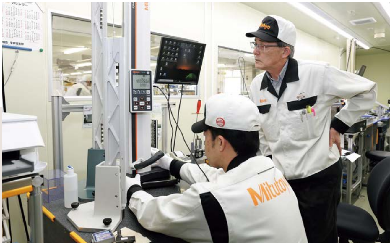
1/1000mm 単位で計測できる「高性能高さ測定器」の測定方法を指導。「正確に測定するには、対象物に測定子をソフトにあてることがコツ」と山納さん
