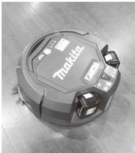
業務用ロボット型自動掃除機（左）、身体への負担を大幅に軽減できるアシストスーツ（右）
