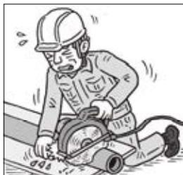
**事例2** 電動丸ノコを使用して端材を切っていたが、端材が小さかったのでノコ刃に手があたり負傷した。
