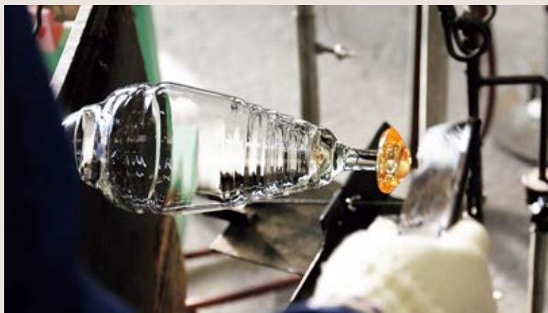
パフェグラスの脚の先に台をつくる。熟練が求められる技能の一つ
