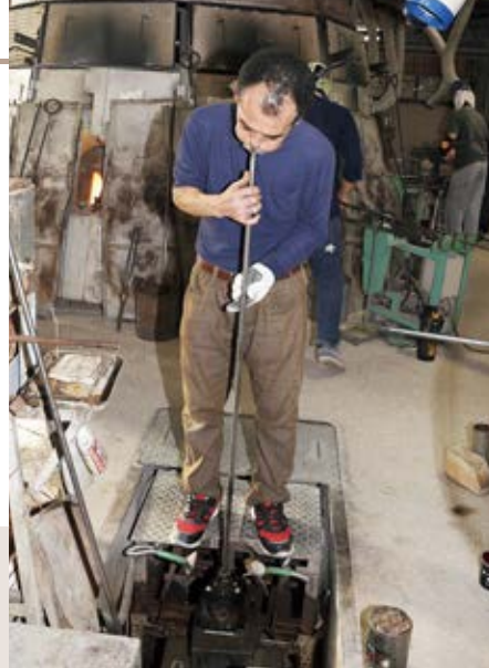
足下の型のなかに竿で巻き取ったガラス 生地を入れ、空気を吹き込み成形する
