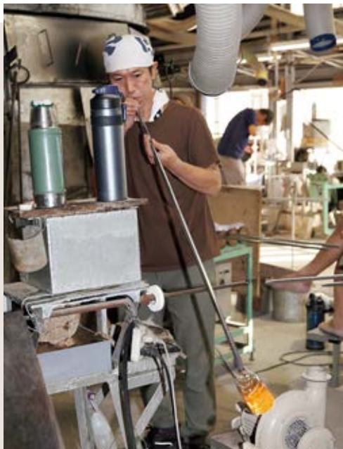
鉄製の竿を常に回しながら空気を吹き込んで形を整える
