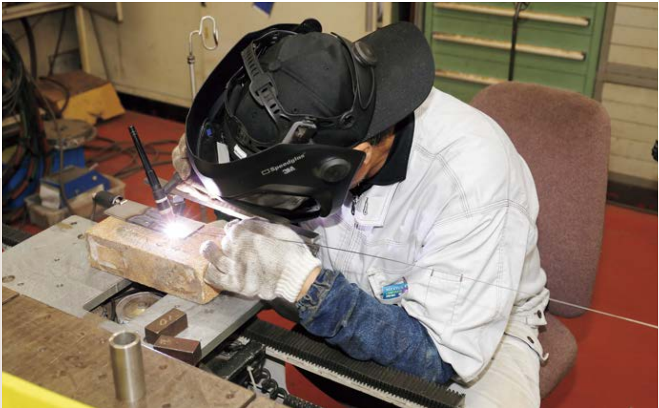
TIG 溶接では、左手に持つ溶接棒を均一の速さで送り出すことで、美しいビードを形成。腕を乗せることで溶接位置を自動で移動できる装置も自作した
