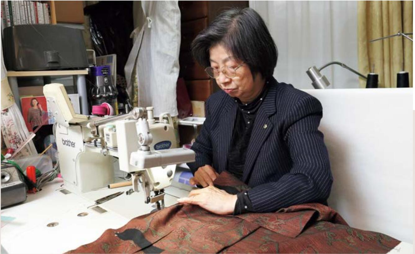
ミシンで2枚の布を重ねて縫うと、上の布は押さえられ下の布は送り歯で送られるため、必ずずれが生じる。練習を重ね、ずらさず縫うコツを体で覚えた
