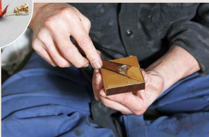
下地塗り。砥の粉と漆を練りあわせ、へらで塗り、乾燥後に研いで平らにする
