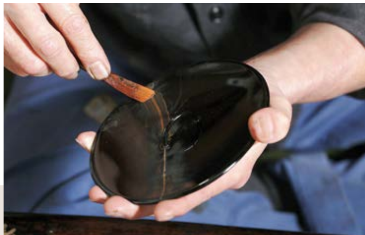
ひびの入った器の蓋を修理。塗りと研ぎをくり返して直していく
