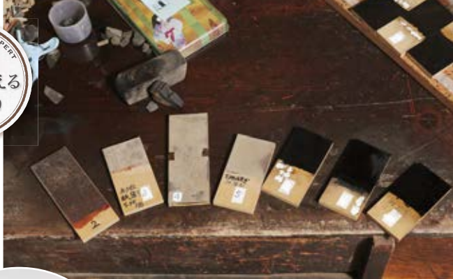
漆塗りの工程を示した見本。左から下地塗り・研ぎと漆塗り・研ぎを数回ずつくり返してツヤを出す
