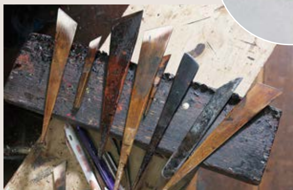
塗りに用いるへら。塗りやすさを考え、自分で板を削ってつくる
