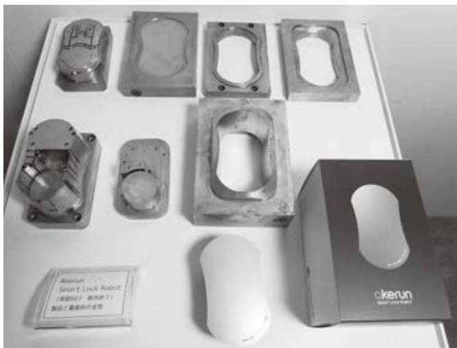
量産開始時に製造した金型と実際の製品（写真提供：株式会社 Photosynth）
