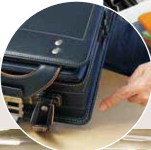
ミシンで縫われたランドセルの前側の部分を裏返し、治具を使ってきれいに形を出す。かなり力のいる作業だ
