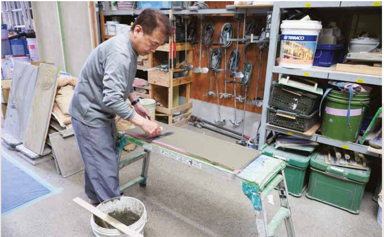
造形用のモルタルを平らに塗り、その上に木目を描く「擬木」。コテを使って手際よく仕上げていく（63 ページ左上の写真が完成した姿）
