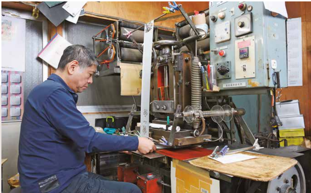
手差しで1枚ずつ加工する半自動箔押機。版を付けた熱板で、箔と紙などの素材に圧力をかけることによって、素材に箔を定着させる
