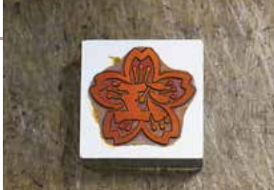
箔押の準備①：箔押に不可欠な版は、製版会社に外注する。この版を箔押機の盤につけ、熱と圧力で箔を紙などの素材に転写する
