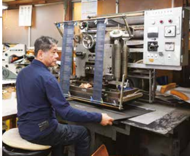
幅 80cm までの箔押ができる半自動箔押機。面積が広ければ広いほど、箔を均一に定着させるためのムラ取りの難易度が増し、調整に時間がかかる
