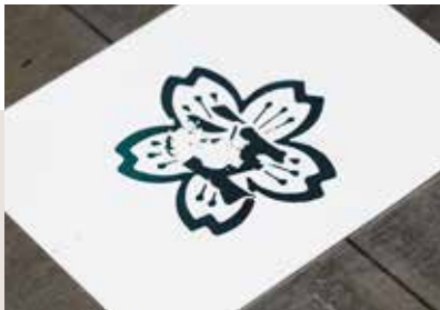
箔押の準備②：①の版を使って、試しに箔押したもの。箔が転写されていない白い部分(=ムラ)をなくす必要がある
