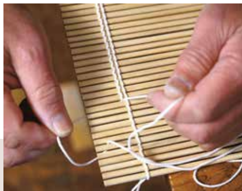
文字や絵を表現した「型抜きすだれ」。普通に編み、型抜きする部分に印をつけてから、ほどいて不要な部分を切り取り、編み直す
