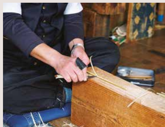
竹ひごを1本ずつ削って形を整える。のり巻きすだれの場合は、巻きやすいように竹ひごの側面の形をかまぼこ型に仕上げる
