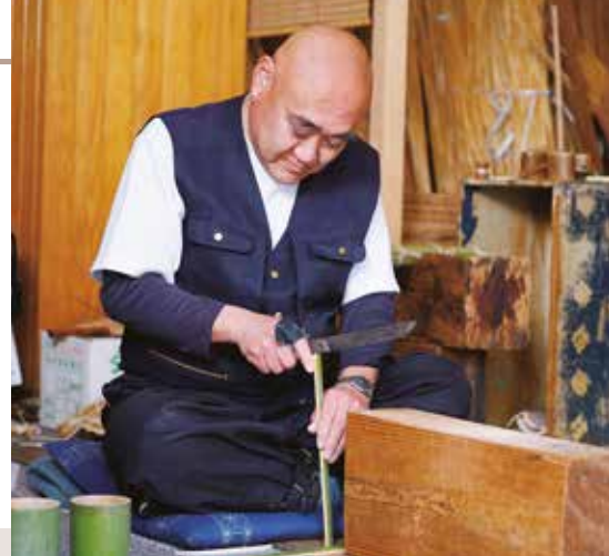
すだれづくりは材料の下ごしらえから始まる。竹は洗って乾かした後、割って竹ひごにする。小刀で割りながら、材料の良し悪しを感じ取る
