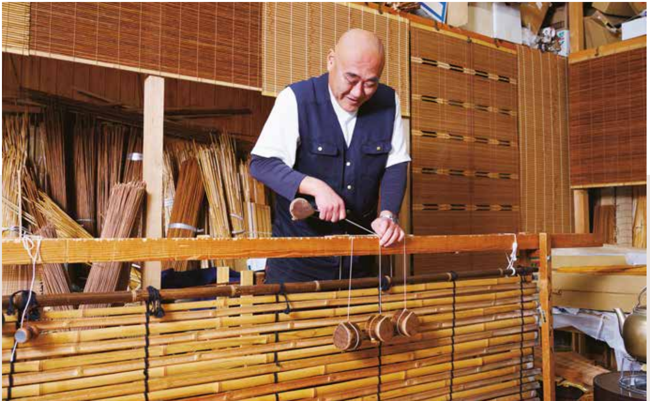
「桁」と呼ばれる台に、必要な長さの糸を巻きつけた「投げ玉」をセットし、竹ひごを1本ずつ載せて、投げ玉を前後に交差させながら編んでいく
