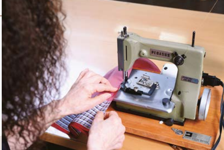
三角形に裁断した生地2枚を、チェーンステッチで縫いあわせる。その際、上の生地と下の生地が進み具合が異なるため、柄がずれやすい。そのため、二つの生地がずれないように生地を引っ張り調整しながら縫っていく
