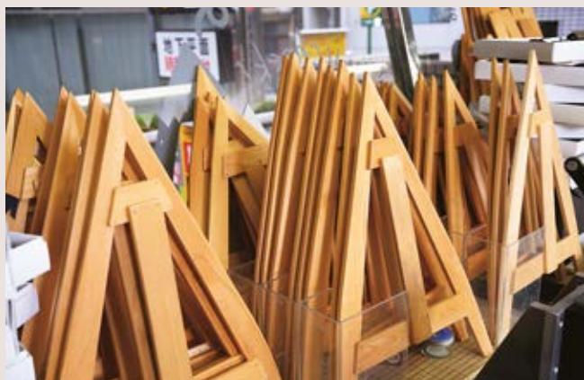
生地の裁断に用いる木型。生地によって伸縮の度合いが異なるため、市原では同じ骨を使う傘でも、生地の種類ごとに木型をつくって対応している
