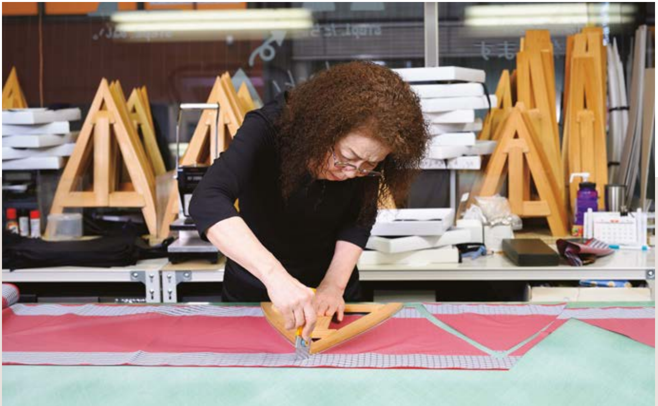
経験が重要な工程の一つが生地の裁断だ。生地によって伸び率が異なるため、それを考慮した型をつくり、その型を使って生地を1枚ずつ裁断していく
