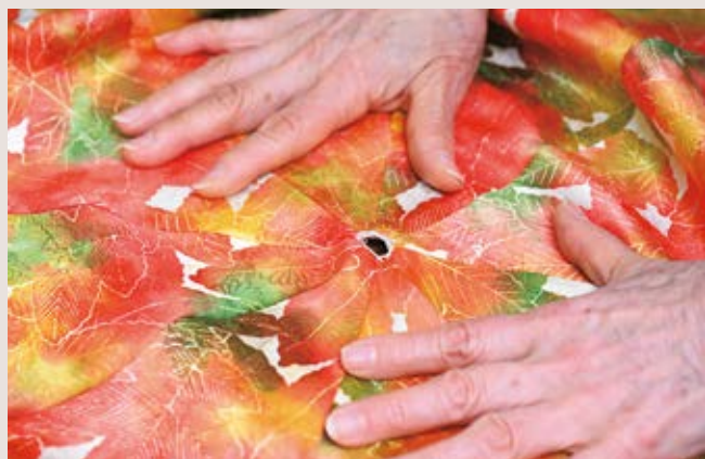
三角形の生地を8枚縫いあわせると、傘のカバーができあがる。中心部分の中棒を通す穴の周囲を補強するための「天かがり」は手で縫いあわせている
