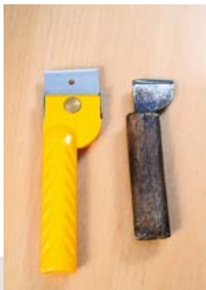
生地裁断用のカッター。右は奥田さんが長年愛用してきた小刀。くり返し研いで刃が短くなっている
