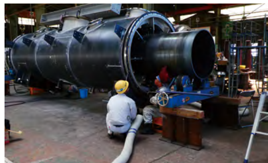
〈タンク自体を回転させ同じ姿勢で溶接〉
