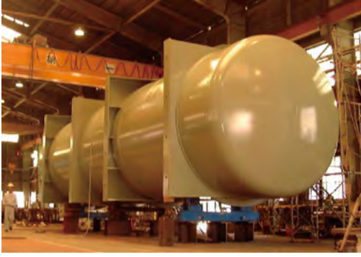
<製作実績例:精製四塩化チタン200tタンク>
