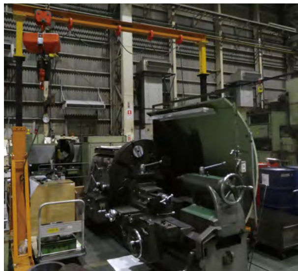
〈小型クレーンとLED照明を設置した旋盤〉
