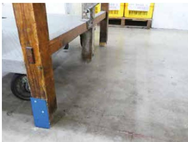
〈作業台の高さを調整している様子〉
