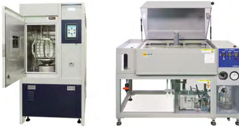
同社の製品（左：促進耐候性試験機、右：腐食促進試験機）
