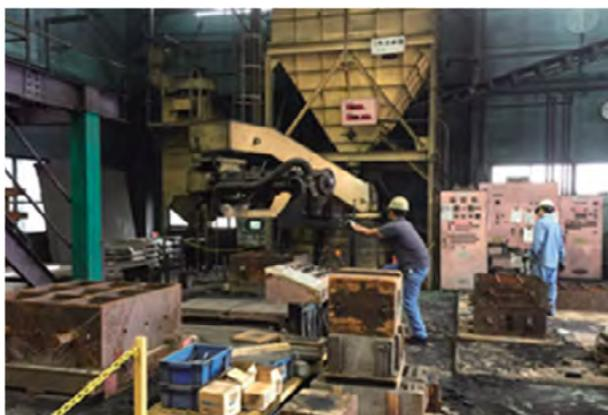
油圧シリンダ付アームがついたミキサーによる作業
