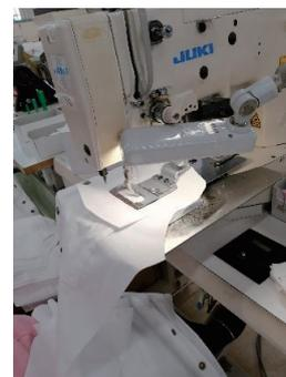
(右：スイッチを踏むと自動で縫製作業が進むミシン)
