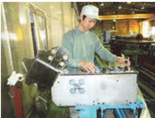
写真 15-1 ラッピング条件の設定を行う（改善後）
