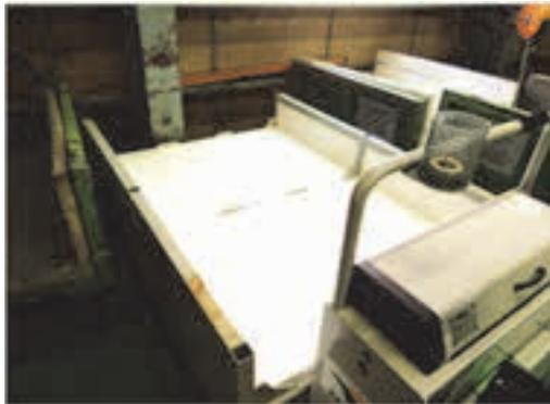
写真 14-1 試作した鉄芯運搬車両（改善後）
