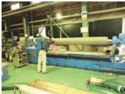
写真 12 ペーパーを使って手作業で研磨する (改善前)
