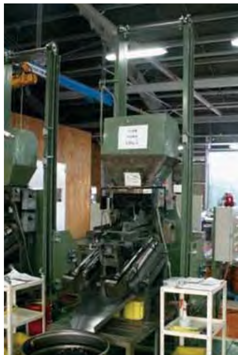
写真4 導入されたローラー選別機用ドラム缶投入機
