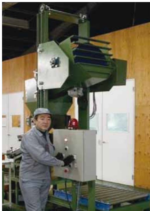
写真4 導入されたローラー選別機用ドラム缶投入機
