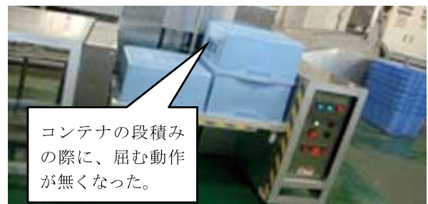
写真28 洗浄機の搬出口（改善後）④
