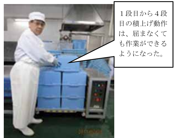
写真29 コンテナ積上げ作業（改善後）
