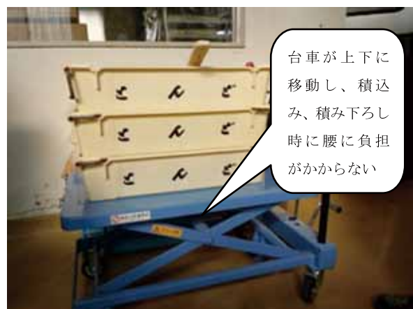
写真4 重量物搬送支援装置(改善後)
