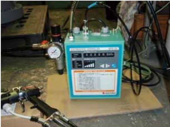
写真13 静電塗装システム
