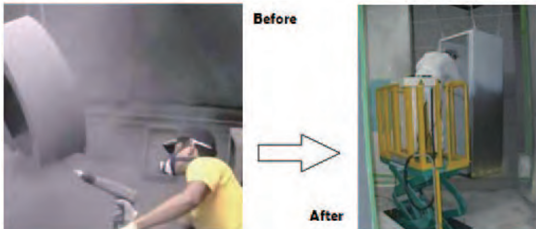
図表IV-4-3 塗装場面（塗装ブースにはリフターの導入で無理な姿勢排除）
