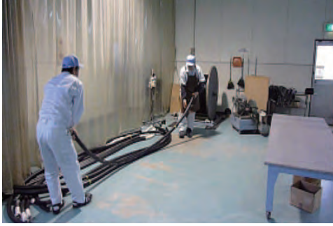
改善前・カット済みケーブル移動
