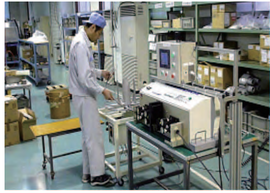
改善後・ケーブル測長・カット
