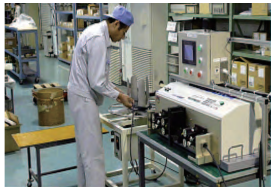
改善後・ケーブル機械巻取り
