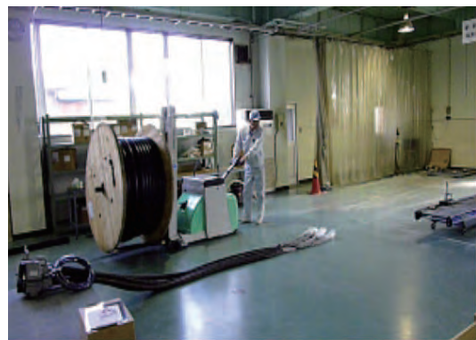
改善後・ケーブルリール移動
