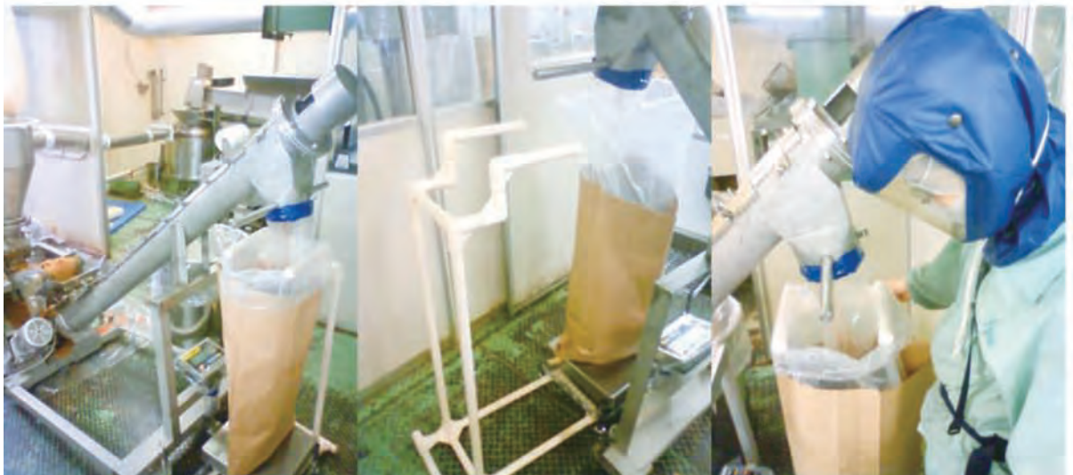
【改善後】スクリーコンベアと専用の受け台を設置し、立ったまま袋に充填可能になった。
