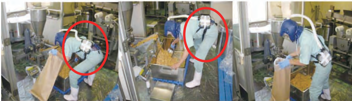
【改善前】従来は、床に専用受けを置き、スコップを使用して袋に充填作業をしていた。
