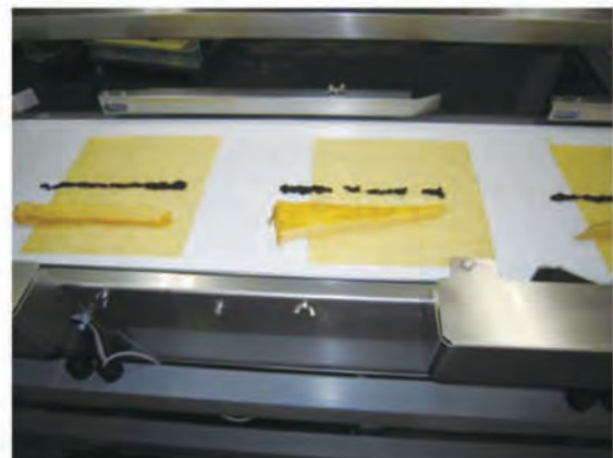
写真 10-6 玉子カットとゲル材塗布の不正確
