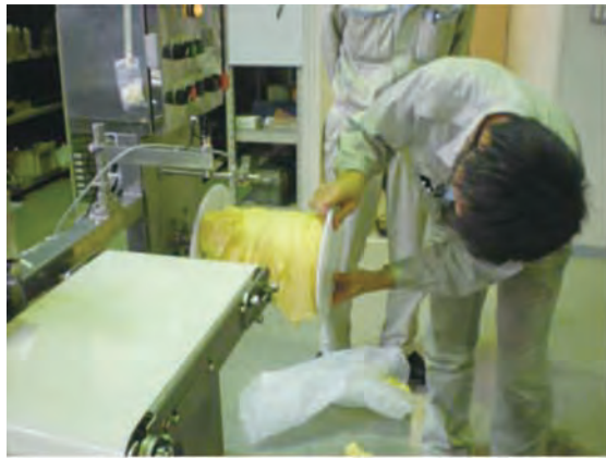
写真 10-1 錦糸シートがボロボロになる
