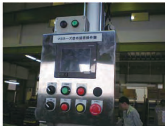
写真 19-2 マヨネーズ塗布機の指示モニター
