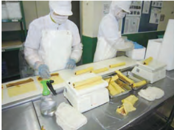
写真 21-1 アナログ計で計って過不足分を写真確認しグラム数を調整していた。
