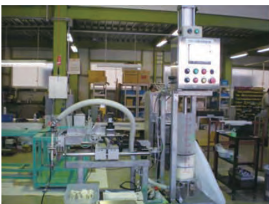
写真9－1 空圧絞りだし方式でのマヨネーズ塗布方式
