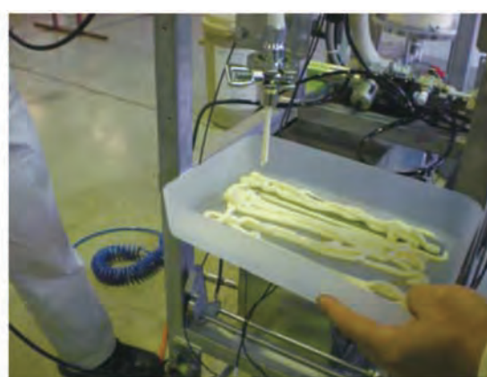
写真9－2 空圧絞りだし方式でのマヨネーズ塗布状況
