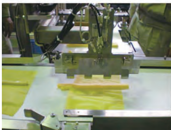
写真 10-3 錦糸シートのサイズが小さい
