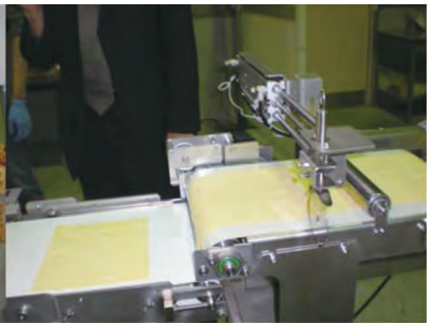
写真6 試作中の“錦糸シートカット供給機”
