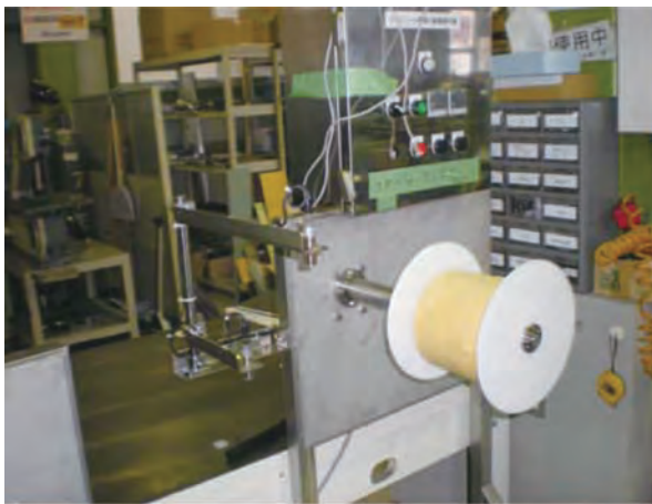
写真5 試作中の“錦糸シート巻き取り機”
