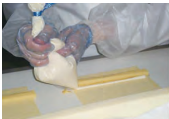
写真 15-1 導入前のマヨネーズ塗布作業
