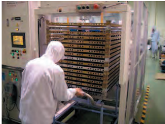
図表26 アンスタッカー装置部への空き殺菌用トレーのセット
