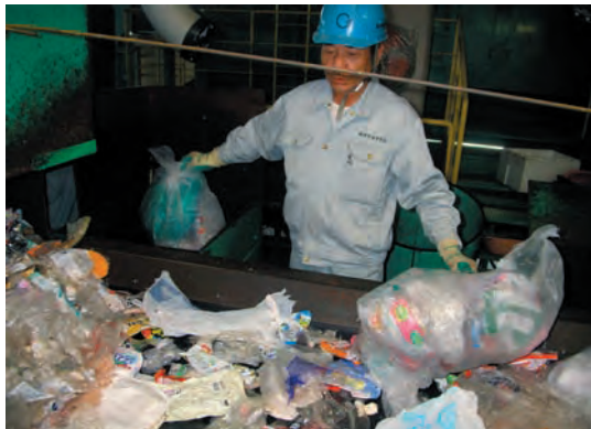
未破袋品抜取り作業
