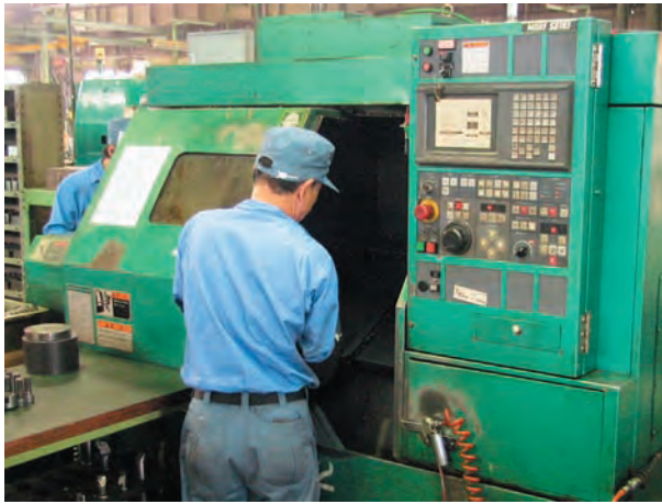
写真-10 NC旋盤のチャックにワークを取り付ける様子
