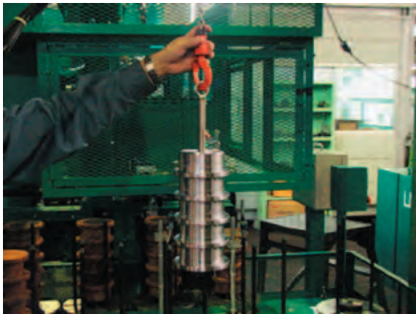
写真－14 NC旋盤にて加工、刻印されたストッカー上のワークを吊り棒にて搬出している様子
