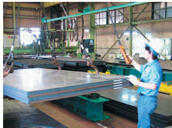
写真－2 鋼板をクレーンで吊り上げる作業
