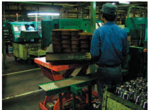
写真-12 ワークを載せたパレットを昇降回転させるマワールとテーブルリフタ
