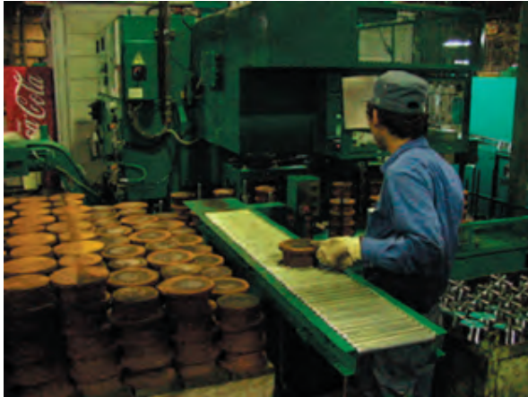
写真－13 ワークをパレットからローラーコンベヤ上に移し、ワークを手で押し、転がしながら搬入している様子
