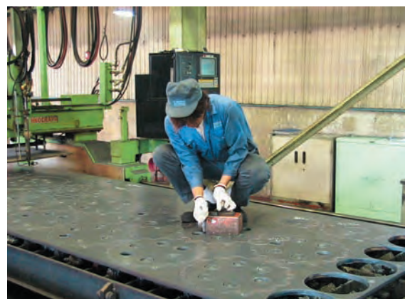
写真－3 溶断後の作業
