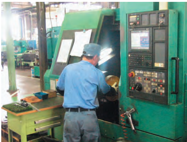
写真-11 チャックに取り付けたワークを再度押し付けながらチャッキングしている様子
