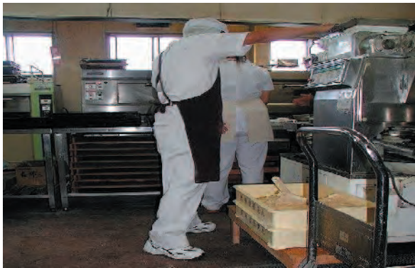
図2 旧包餡機の場合材料投入口高さ
