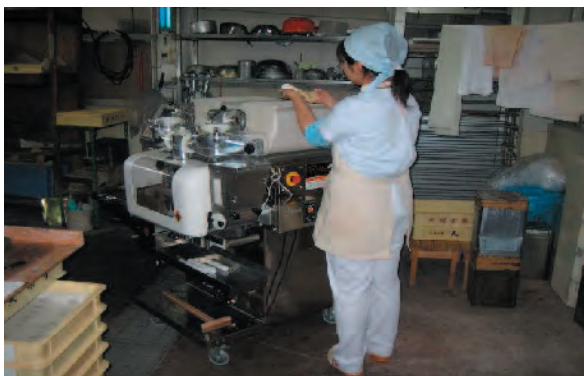
図3 新規包餡機の場合材料投入口の高さ
