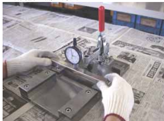
図表 - 4 - 19 ダイヤルゲージでの測定
