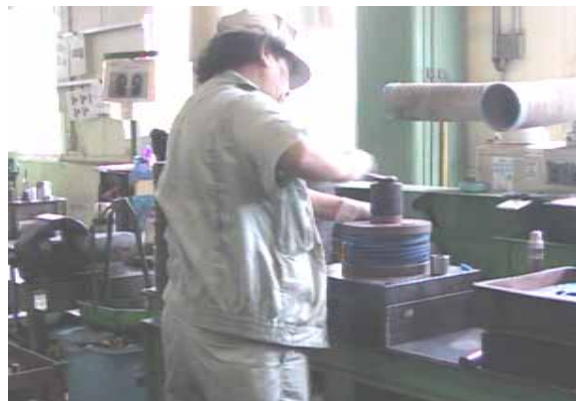
図表 - 3 - 2 上型を被せて仮締め
