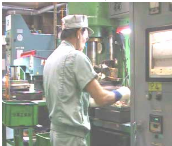
図表 - 3 - 3 定盤で歪みの確認
