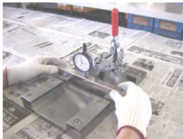
図表 - 3 - 5 平面度測定
