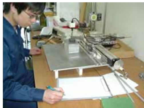
図 37 従来の測定装置による磁場測定 従来の装置で測定された一例が表 5 に示されている。
