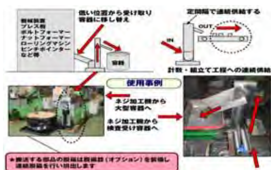
図 20 磁気搬送装置
