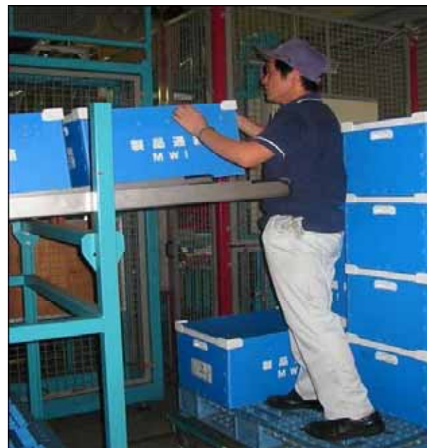
図 16 . 部品供給のローラー・コンベヤ（改善前）
