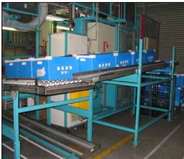
図 17．部品供給のローラー・コンベヤ（改善後）
