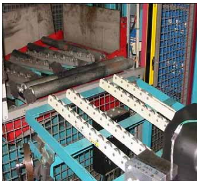
図 15 . 気密検査工程への送りリフトの受け台（改善後）
