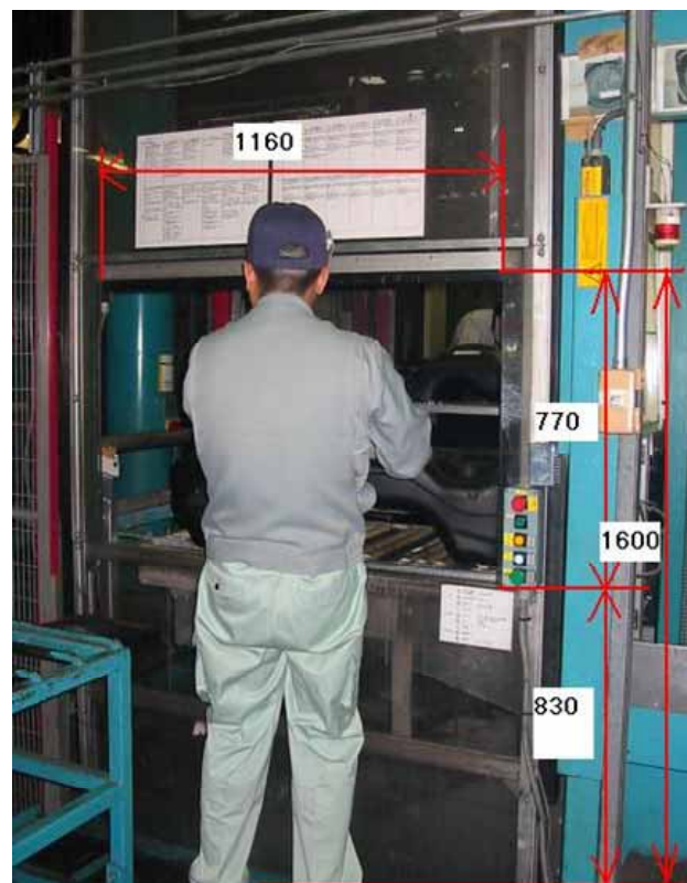
図6．防御用シャッター寸法（改善前） 組立て工程
