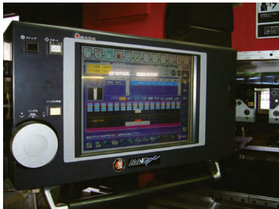
写真4. 画面上で呈示（見える化）されるパンチの取り付け位置
