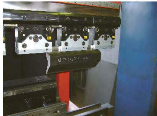
写真 15. 刃具取り付けとチャック部
