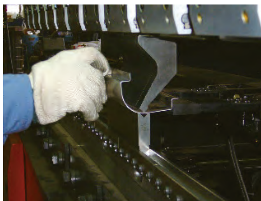
写真 22. 曲面の加工状況
