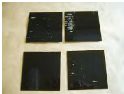
図表 6 ジクロロメタン脱脂後、イオン水洗浄・脱脂後亜鉛メッキ鋼板(ZC 材)油分残留試験結果比較図
