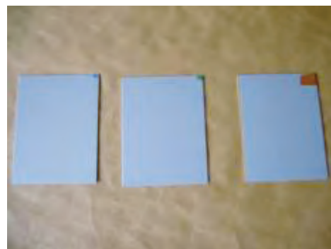
図表 5 イオン水洗浄・脱脂後 ZC 材曝露試験結果
