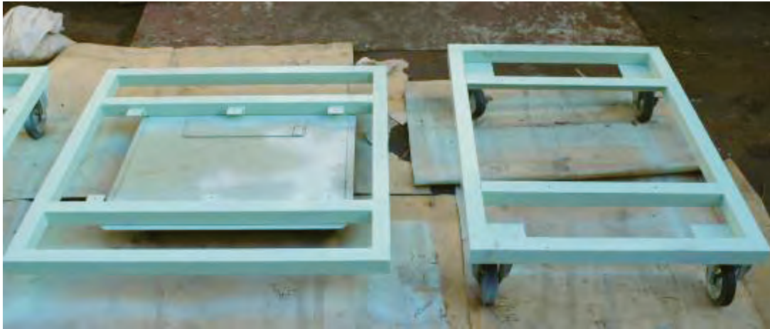
図表 22 試作昇降テーブル改造部位
