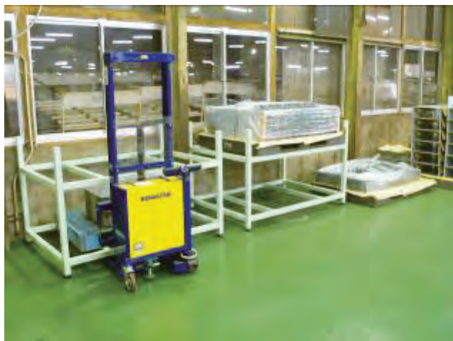
図表 25 次作業棚と簡易リフト
